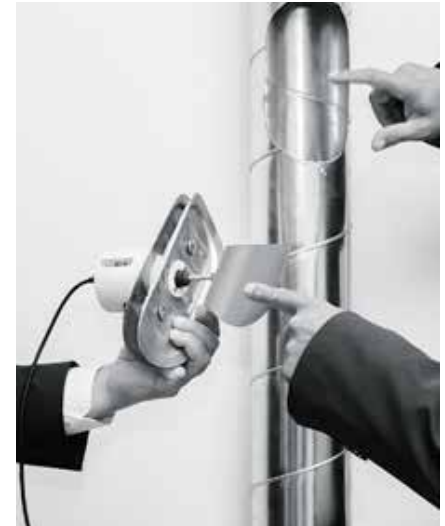
Die kostengünstige, plombierte Überwachungseinheit wird an der Revisionsöffnung montiert und misst über eine aerodynamische Ablagerungsfläche die Masse der Ablagerung.
