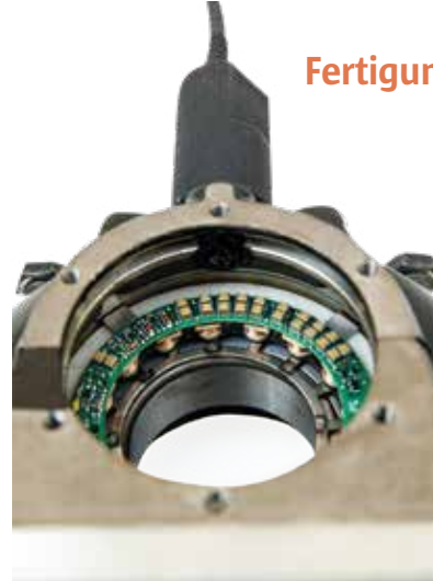
Innenleben: Der Modular-Sensor samt Metallring, Spulen, Kondensatoren als Energiespeicher, Temperatursensoren, Mikrocontroller und Antenne. Dahinter der Reluktanzring und das Wälzlager von NKE.
